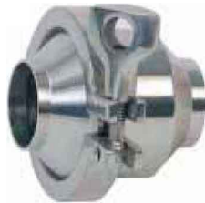
fig 281 vlinderklep RVS304 draad/draad 1" - 4" draad/draad volgens DIN 11851 huis : RVS 304 dichting EPDM (andere op aanvraag) max. druk : 10 bar / max. temp. : +120°C fig 286 dubbelwerkend pneumatisch fig 287 enkelwerkend pneumatisch
