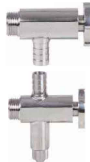
fig 888 peilglaskraan boven RVS304 fig 889 peilglaskraan onder met aflaat 1/2" bsp - slangpilaar 14 mm huis : RVS 304 dichting PTFE max. druk 10 bar
