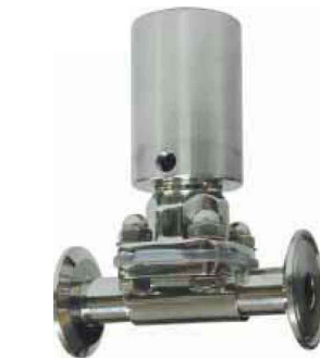
fig 293 membraanafsluiter RVS316L pneumatisch enkelwerkend NC 1/2" - 2" clamp/clamp huis : RVS 316L membraan SILICONE max. druk : 10 bar / max. temp. : +95°C gepolijste uitvoering
