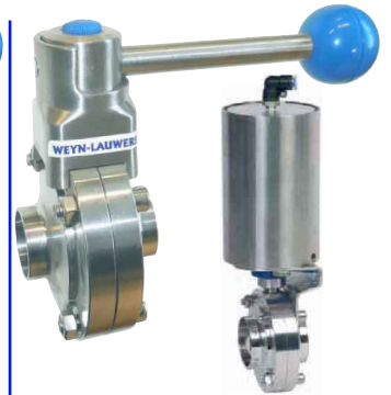
fig 283 vlinderklep RVS304 las/las 1" - 4" las/las huis : RVS 304 dichting EPDM (andere op aanvraag) max. druk : 10 bar / max. temp. : +120°C fig 290 dubbelwerkend pneumatisch fig 291 enkelwerkend pneumatisch
