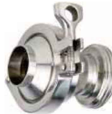
fig 282 vlinderklep RVS304 las/draad 1" - 4" las/draad volgens DIN 11851 huis : RVS 304 dichting EPDM (andere op aanvraag) max. druk : 10 bar / max. temp. : +120°C fig 288 dubbelwerkend pneumatisch fig 289 enkelwerkend pneumatisch
