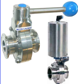
fig 280 vlinderklep RVS316L clamp/clamp 1" - 4" clamp/clamp huis : RVS 316L dichting EPDM (andere op aanvraag) max. druk : 10 bar / max. temp. : +120°C fig 284 dubbelwerkend pneumatisch fig 285 enkelwerkend pneumatisch
