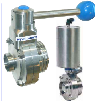
fig 282 vlinderklep RVS304 las/draad 1" - 4" las/draad volgens DIN 11851 huis : RVS 304 dichting EPDM (andere op aanvraag) max. druk : 10 bar / max. temp. : +120°C fig 288 dubbelwerkend pneumatisch fig 289 enkelwerkend pneumatisch
