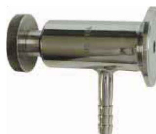
fig 296 terugslagklep RVS304 las/las 1" - 4" las/draad volgens DIN 11851 huis : RVS 304 dichtingsring SILICONE max. druk : 10 bar max. temp. : +95°C gepolijste uitvoering
