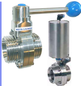
fig 281 vlinderklep RVS304 draad/draad 1" - 4" draad/draad volgens DIN 11851 huis : RVS 304 dichting EPDM (andere op aanvraag) max. druk : 10 bar / max. temp. : +120°C fig 286 dubbelwerkend pneumatisch fig 287 enkelwerkend pneumatisch
