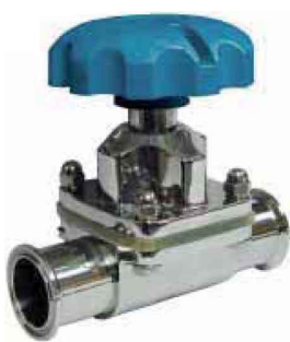
fig 292 membraanafsluiter RVS316L 1/2" - 2" clamp/clamp huis : RVS 316L membraan SILICONE max. druk : 10 bar max. temp. : +95°C gepolijste uitvoering
