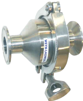
fig 294 terugslagklep RVS316L clamp/clamp 1" - 4" bsp clamp/clamp huis : RVS 316L dichtingsring SILICONE max. druk : 10 bar max. temp. : +95°C gepolijste uitvoering
